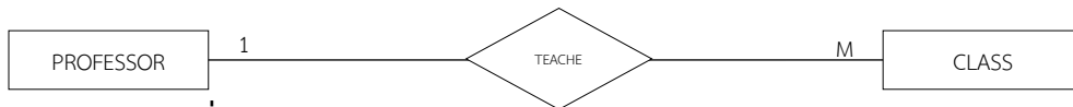
ภาพที่ 2.3 แสดงความสัมพันธ์แบบ One To Many Relationships
